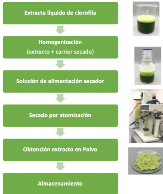
**Figura 7.4.** Diagrama de flujo a escala laboratorio para obtención de extracto clorofila en polvo, mediante secado por atomización.
