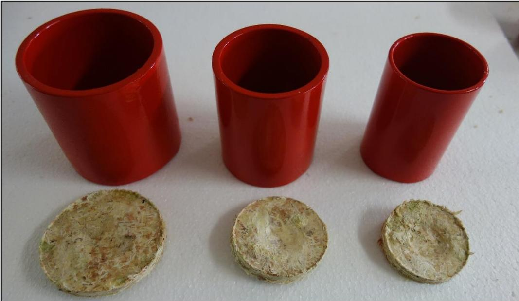
**Figura 38.** Cilindros matrices para el prensado de musgo y obtención de discos de *Sphagnum* deshidratado con diferentes diámetros.
