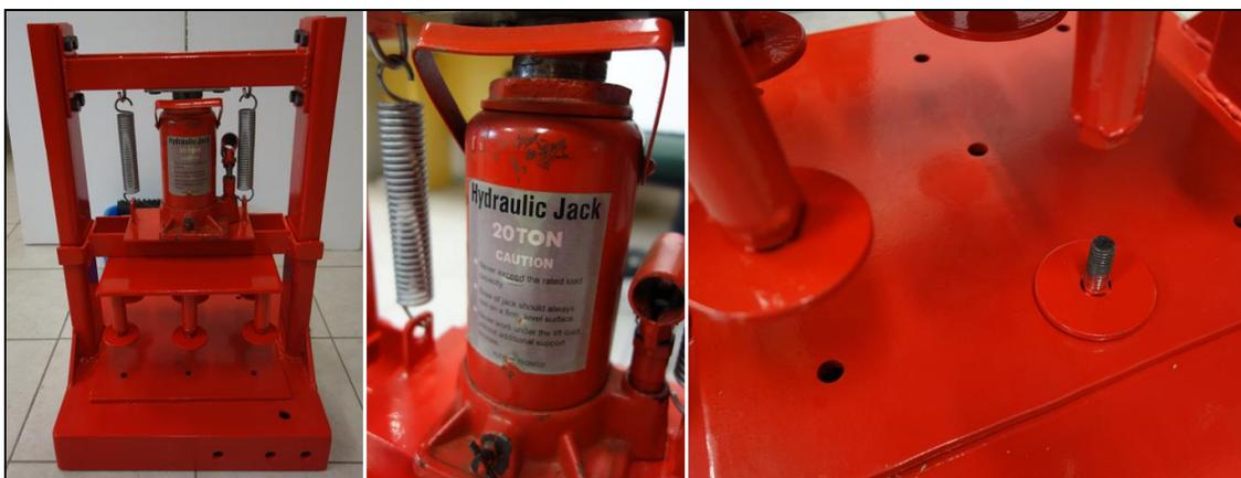
**Figura 52.** Sistema hidráulico manual para prensado de musgo *Sphagnum*.
