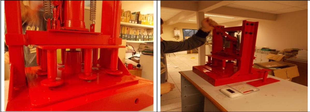
**Figura 57.** Máquina prensadora hidráulica manual adaptada para la obtención de discos de musgo prensado
