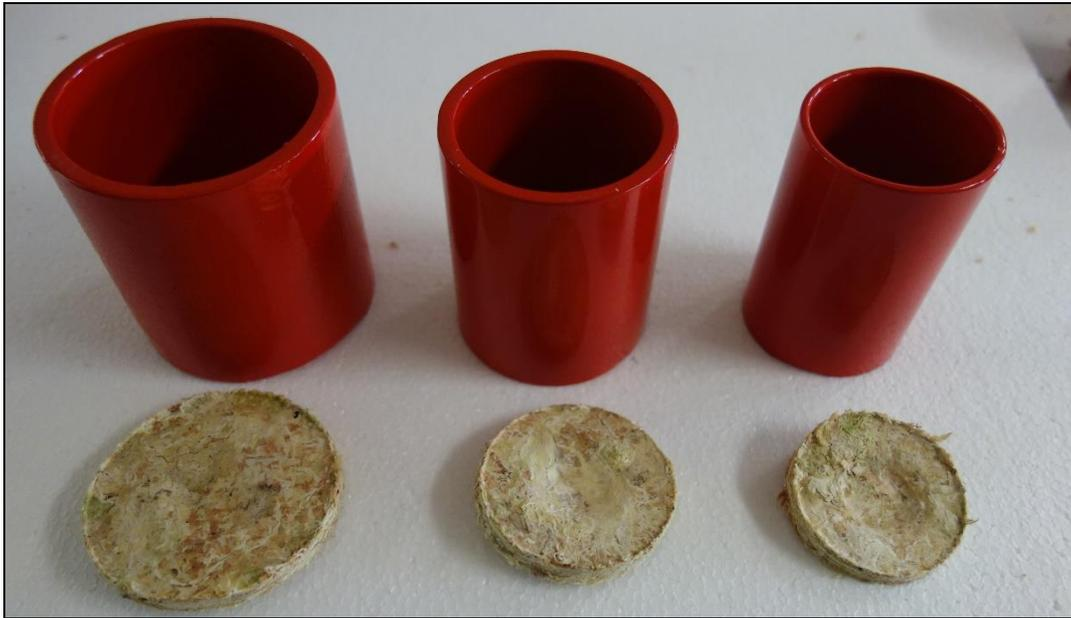
**Figura 53.** Cilindros matrices para el prensado de musgo y obtención de discos de *Sphagnum* deshidratado con diferentes diámetros.
