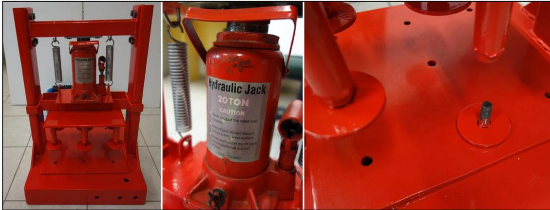
**Figura 16.** Sistema hidráulico manual para prensado de musgo *Sphagnum*.
