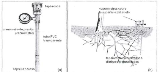
Figura 21. (a): tensiómetro tradicional con las partes que lo componen, (b): esquema de instalación de los tensiómetros.
