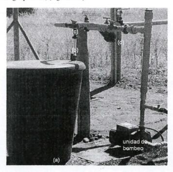
Figura 2.4.3. Equipo de inyección de fertilizantes (agroquímicos en general) compuesto por (a): tambor donde se encuentra la solución madre, (b): caudalímetro, (c): venturi y (d): filtro.
