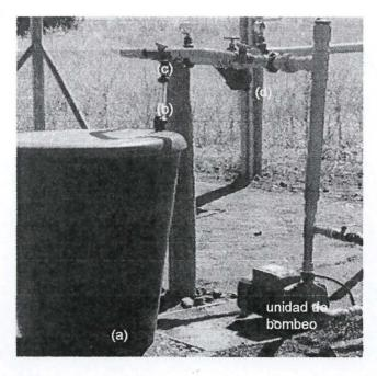
Figura 7. Equipo de inyección de fertilizantes (agroquímicos en general) compuesto por (a): tambor donde se encuentra la solución fertilizante, (b): caudalímetro, (c): venturi y (d): filtro.
