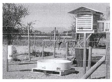
Figura 2.1.1. Instrumentos necesarios para llevar un registro de las condiciones ambientales en una plantación. (a): pluviómetro, (b): bandeja de evaporación Tipo A, (c): higrotermógrafo ubicado dentro de (d): abrigo meteorológico definido como una estructura de medidas estandarizadas que sirve de protección al instrumento.
