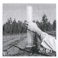
Figura 20. Medición de caudal por gotero, (a): vaso de plumavit bajo el gotero, (b): cronómetro para medir el tiempo de goteo, (c): probeta para medir el volumen caído en el tiempo de goteo establecido, (Antúnez, Mora y Felmer, 2010).
