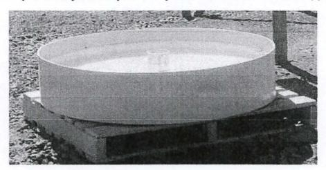
Figura 18. Evaporímetro Tipo A o bandeja Clase A, recipiente cilíndrico enchapado en fierro galvanizado de 121 cm de diámetro y 25.5 cm de alto apoyado en una plataforma de madera que lo eleva a 15 cm del nivel del suelo,
