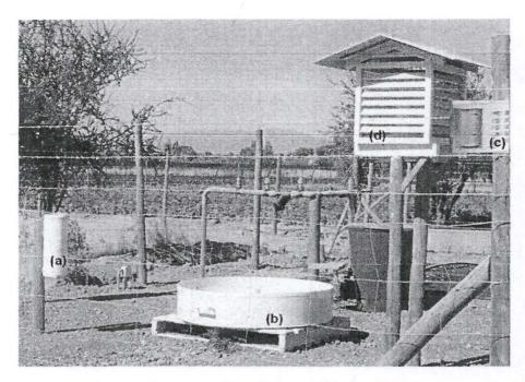
Figura 3. Instrumentos necesarios para llevar un registro de las condiciones ambientales en una plantación. (a): pluviómetro, (b): bandeja de evaporación Tipo A, (c): higrotermógrafo ubicado dentro de (d): abrigo meteorológico definido como una estructura de medidas estandarizadas que sirve de protección al instrumento.
