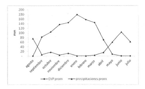
Figura 2.4.14. Gráfico que indica la relación entre la evaporación de bandeja (EVP mm) y la lluvia (mm) caída. Los datos corresponden al promedio de 4 años de registros.
