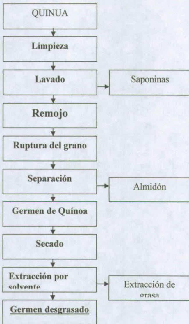
Figura 18: Diagrama del flujo del proceso para la obtención del Germen Desgrasado
