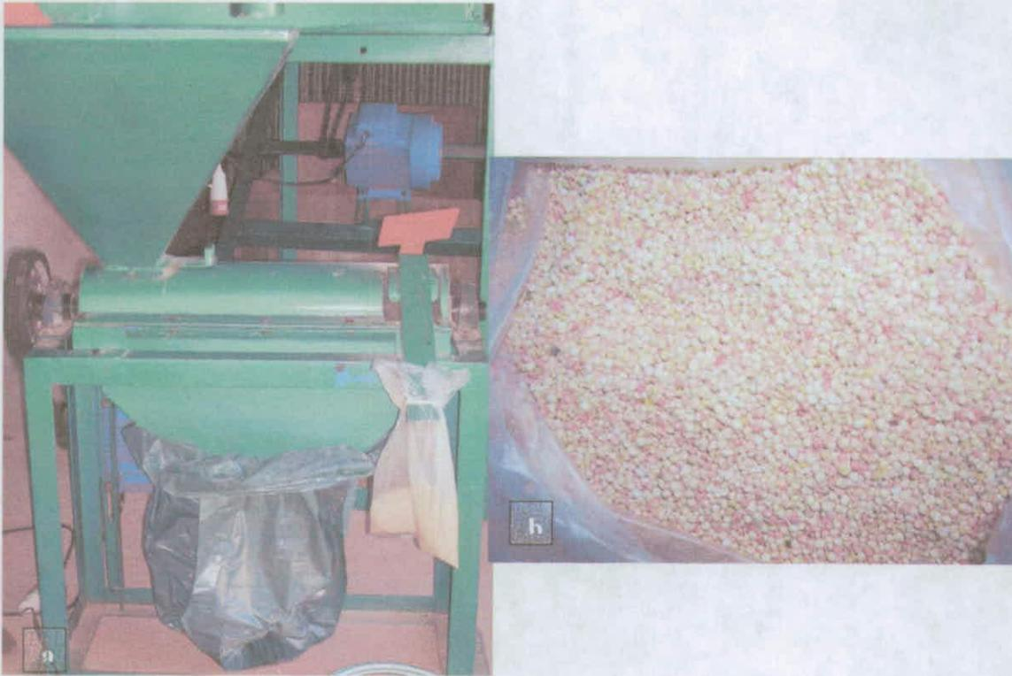
**Figura 100.** Vista lateral del equipo (a) y quinua escarificada (b)
