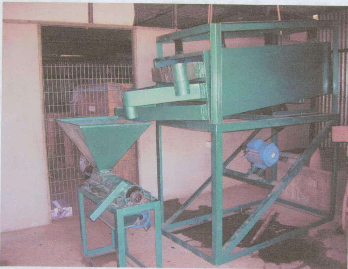
**Figura 95.** Equipo para la limpieza del grano y Escarificador
