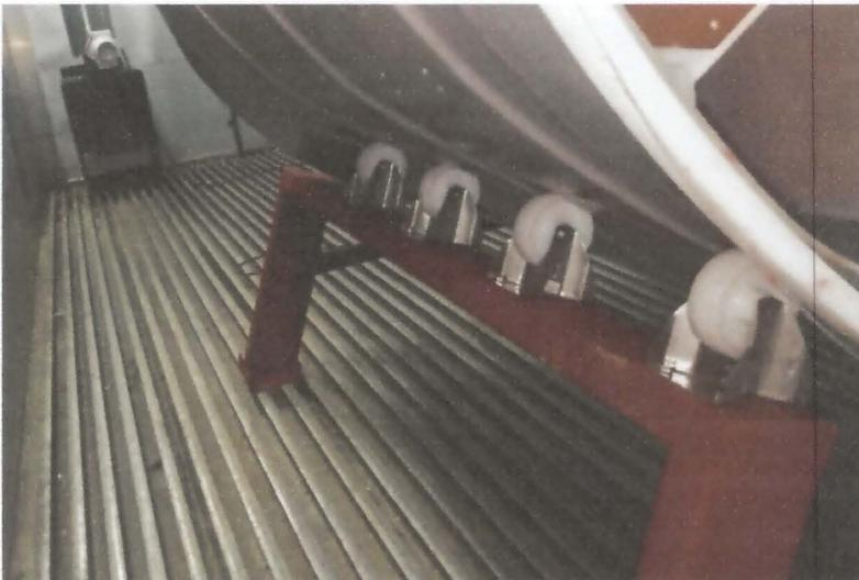
**Figura 17.** Sistema de ruedas como soporte del tambor. Se incorporarán anillos estructurales metálicos al estanque para evitar su deformación por el mismo peso.
