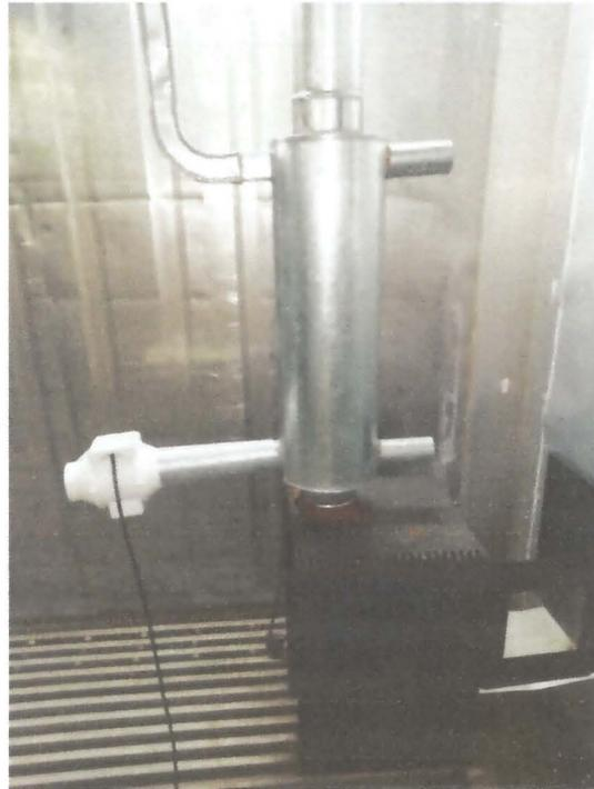
**Figura 22.** Sistema de eficiencia energética compuesta de un tubo de doble camisa y un ventilador,
