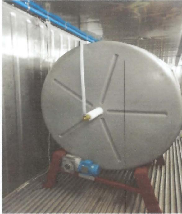
**Figura 16.** Vista posterior de germinador: motor trifásico con regulador de velocidad para la rotación y manguera de alta presión conectada a la junta rotativa y a su vez al interior del sistema de aspersión por medio de la barra perforada de polímero calidad alimentaria.
