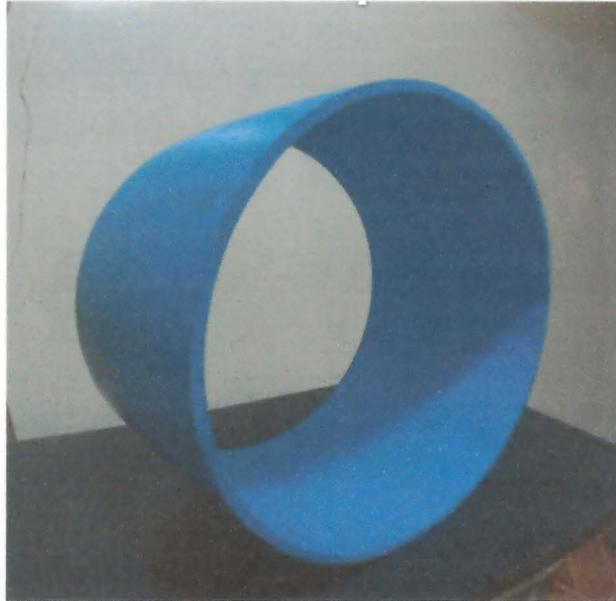
Figura 2. Cañería de PVC hidráulico de 300 mm diámetro interno y espesor de pared de 7 mm utilizada para construcción de mini tambor rotatorio de germinación.
