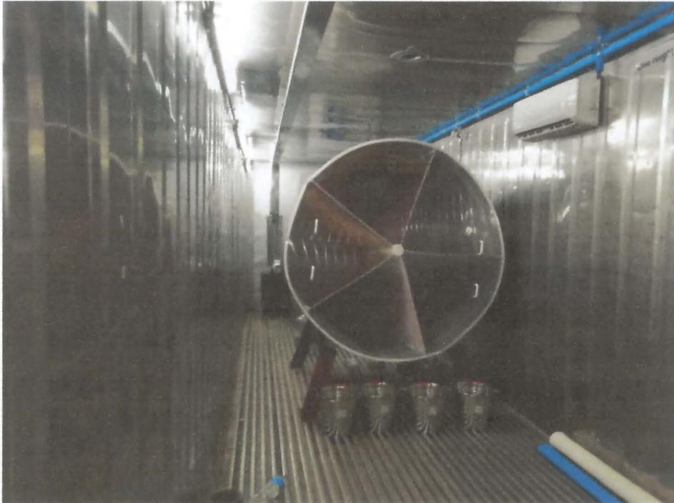
**Figura 12.** Vista frontal de germinador rotativo a escala industrial proporciona 5 compartimientos.
