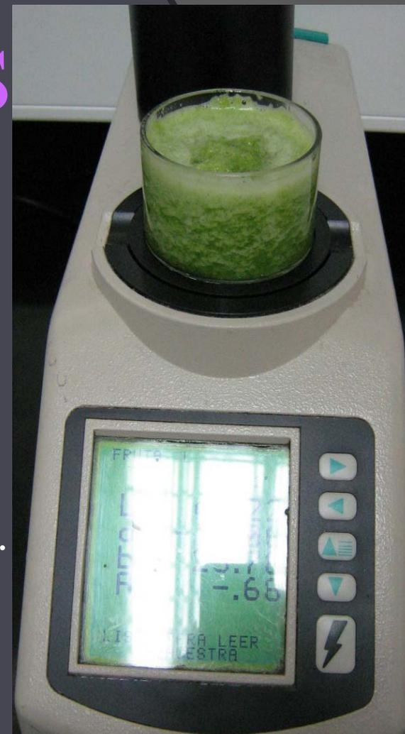
Figura 7: Colorímetro marca Hunter Lab Color Flex CX 1225
