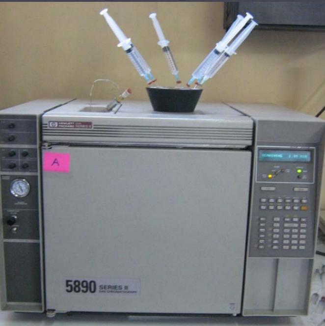
Figura 3: Cromatógrafo de gases 5890 serie II
