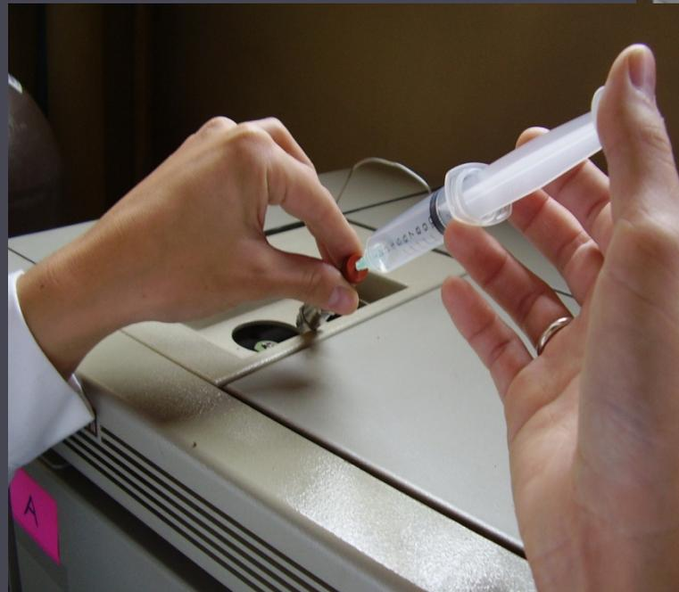
Figura 4: Inyección de gases al cromatógrafo.
