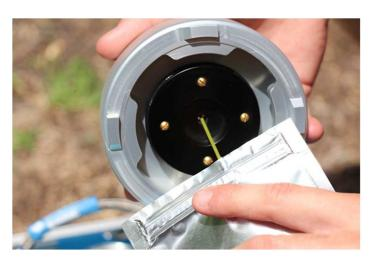
La bomba de Scholander debe estar lista para mover la muestra inmediatamente a la cámara. Es decir, con el cilindro de N2 abierto (medio giro es suficiente, se debe indicar presión en el manómetro) y el control todavía en posición **OFF**.
