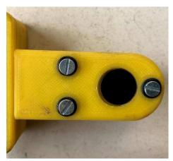
Figura 1.7.- Filtro ND instalado en la pieza cabeza de la carcasa.
