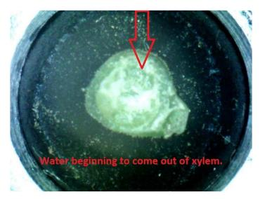
Si se mantiene la presión sobre la hoja, el agua comenzará a formarse en una gota. Si permite que la presión continúe, técnicamente estará más allá del punto final y el agua formará una gota en la parte superior del extremo cortado del pecíolo.
