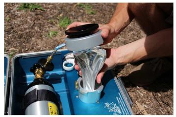
Coloque la hoja y la bolsa juntas en la cámara.
