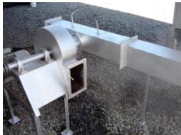
**Foto 5. Extractor de aire, que aumenta la eficiencia de paso del vapor en la aplicación activa.**
