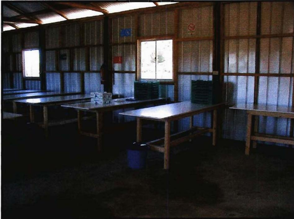
En la foto se aprecia, la disposición de los mesones de embalaje, durante el proceso de la temporada 2003-04, se pensó en un principio embalar con un operador por mesón, sin embargo, se comprobó que el trabajo era más eficiente al realizarlo de a dos personas. También se aprecia la disposición de los basureros con tapa, el extintor y algunas señales éticas.
