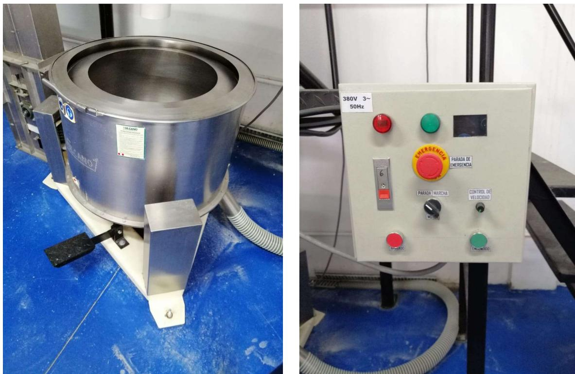
**Figura 18.** Fotografía de la centrifuga de quínoa y panel eléctrico de control
