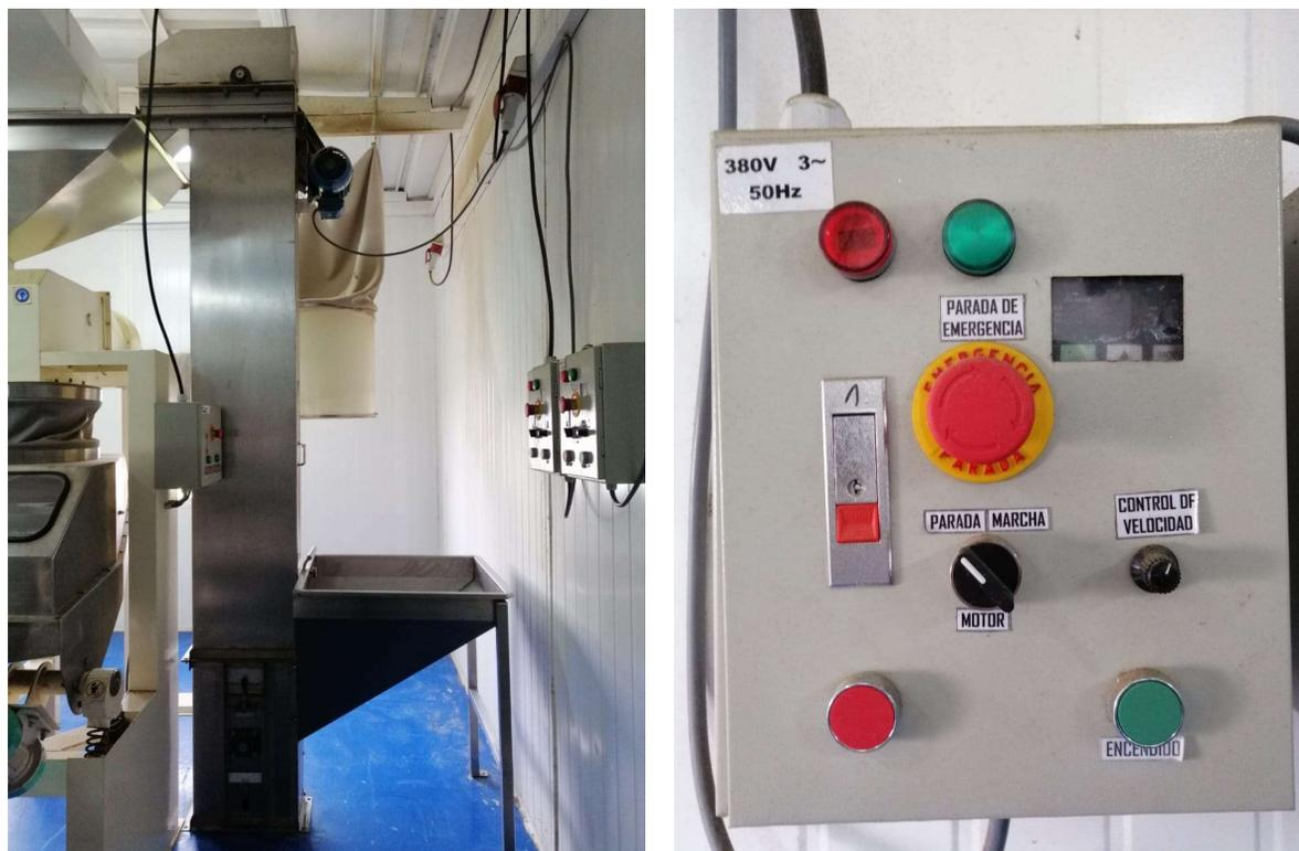
**Figura 3.** Fotografía elevador de cangilones y panel eléctrico de control
