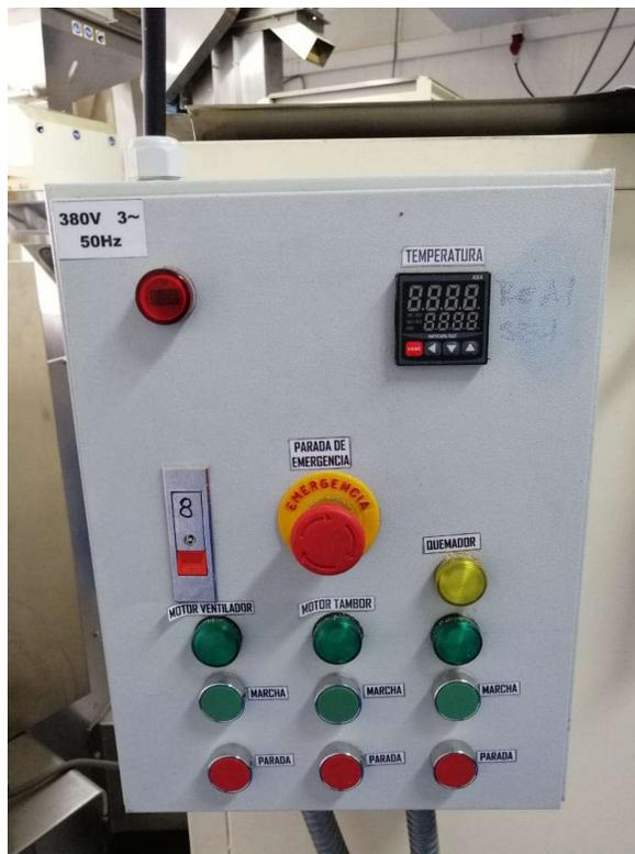
**Figura 21.** Fotografía de vista real equipo secador de granos y panel eléctrico de control
