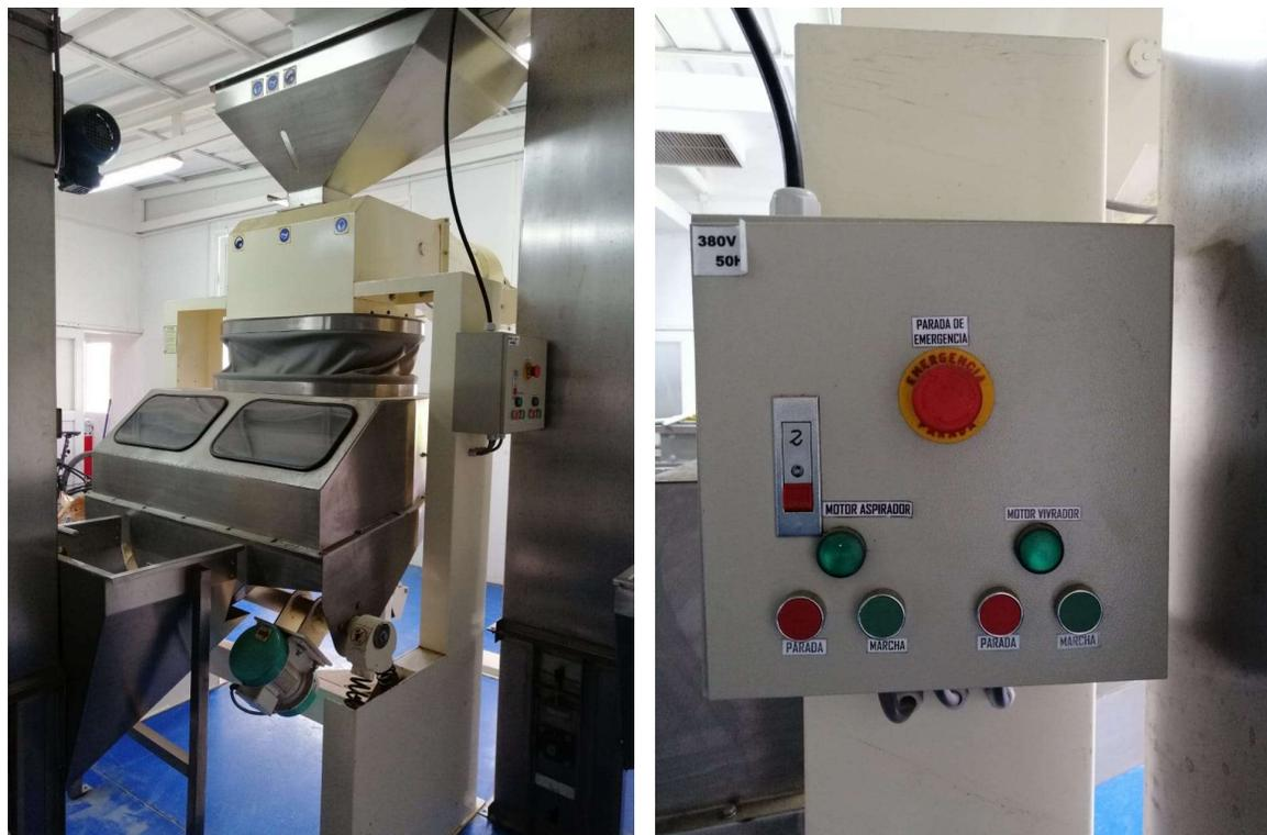
**Figura 6.** Fotografía despedradora y panel eléctrico de control
