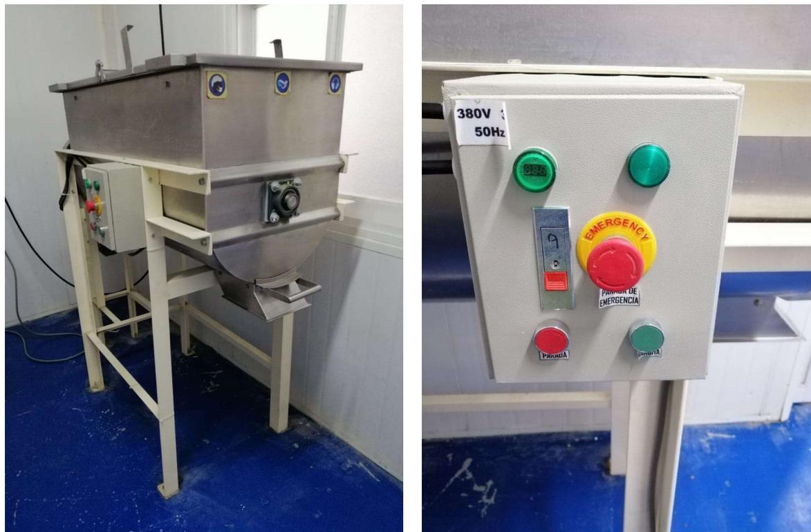
**Figura 30. Fotografías del equipo mezclador y su panel de control**
