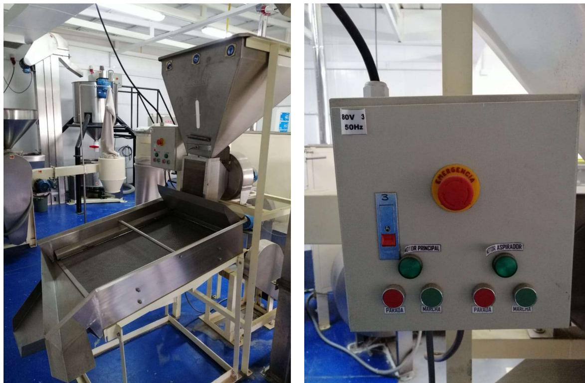
**Figura 9.** Fotografía clasificadora de granos y panel eléctrico de control
