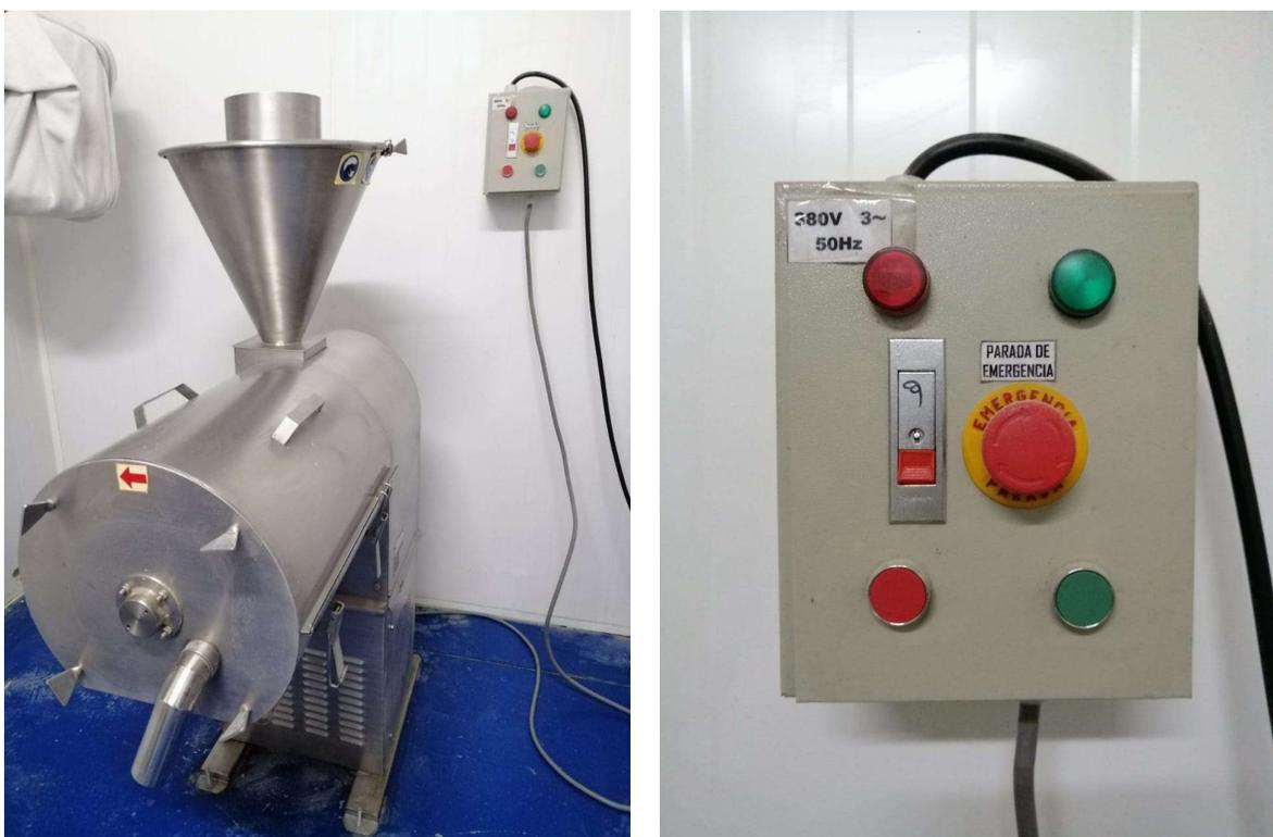
**Figura 27.** Fotografía de tamizador horizontal y panel de control.
