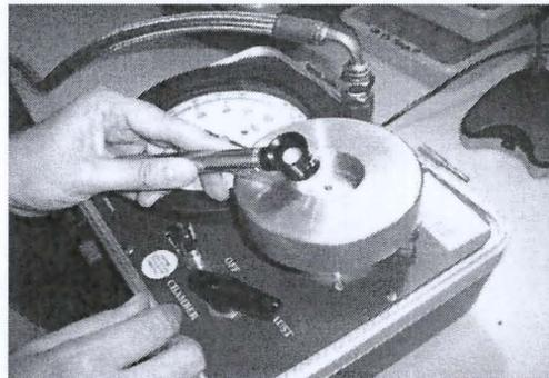
**Foto 4.. Mediciones de potencial hídrico xilemático ( $\Psi$ ) y curvas *presión-volumen* mediante cámara de Scholander.**
