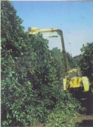
**Figura 107.** Poda mecanizada con la cual se está rebajando el seto.
