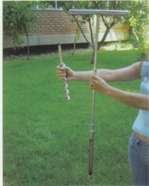
**Figura 119.** El barreno agrológico es una herramienta útil para conocer la humedad del suelo.
