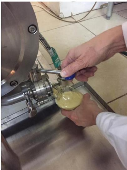
Concentrado luego de hidrólisis de almidones y proteínas, previo al proceso de liofilización
