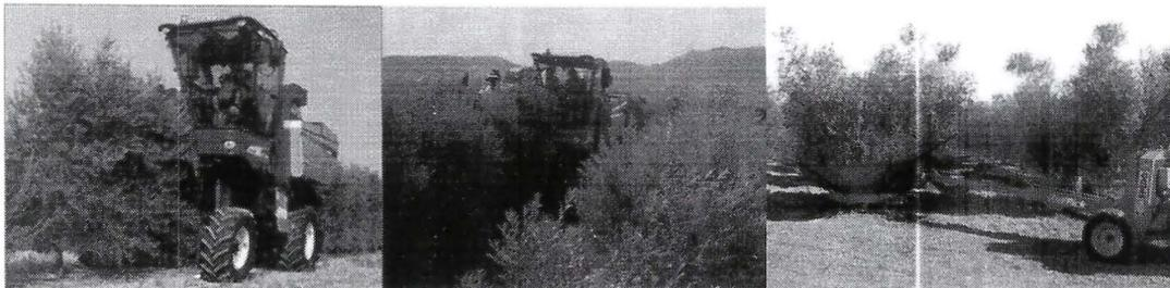
Figuras 6: New Holland VX7090; Cosechadora polivalente de alto rendimiento aplicable a viñas anchas y olivos.
