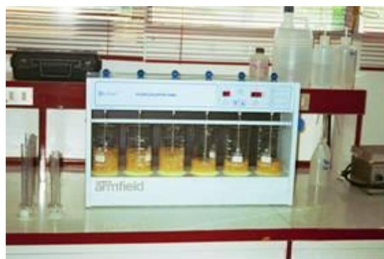
Fotos 6 y 7. Proceso de extracción de solutos desde gargales (*Grifota gargal*): Foto 6) materia prima gargal deshidratado, Foto 7) floculador durante el proceso de extracción.
