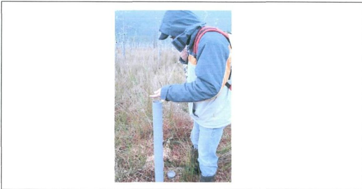
**Figura 2 Detalle de medición del nivel freático**
