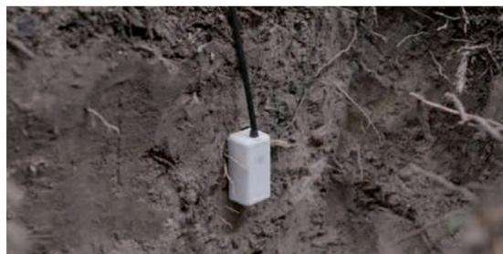
**Figura 17:** Sensor enterrado en perfil de suelo en zona de raíces.
