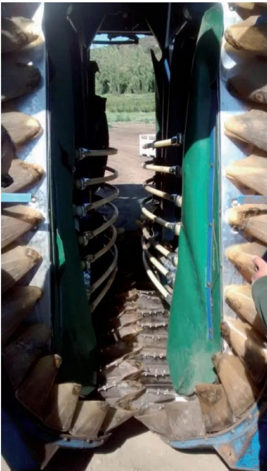
**Figura 31:** Ubicación parcial de las ballestas vibratoras en la máquina.
