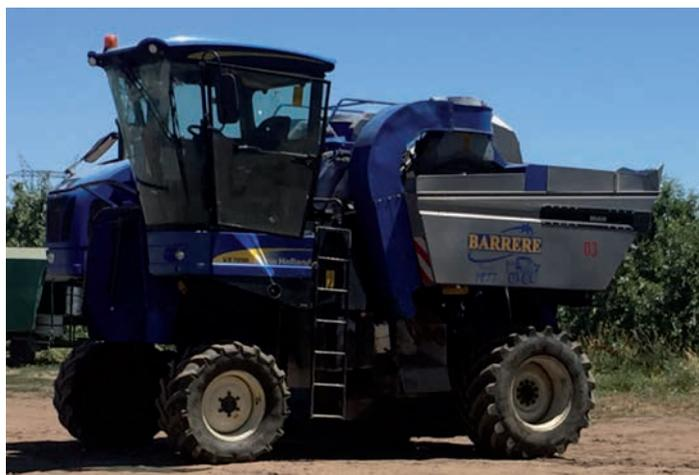
**Figura 35:** Máquina vendimiadora con adaptaciones para olivo New Holland VX7090.
