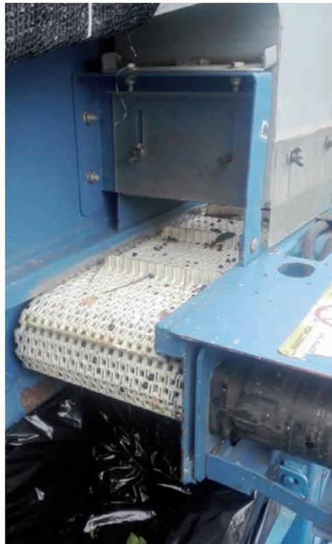
**Figura 34:** Esteras tipo harnero del sistema transportador de frutos.
