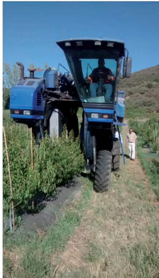
**Figura 32:** Máquina pasando sobre árboles de un solo eje.
