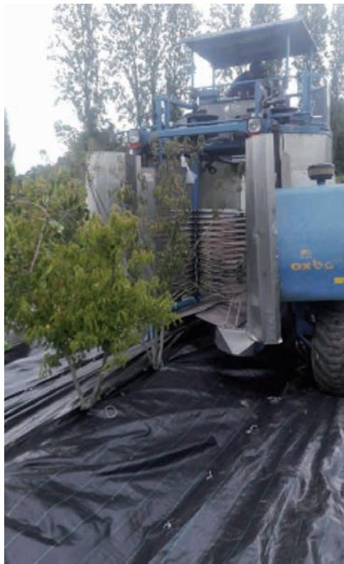
**Figura 33:** Máquina cabalgante cosechadora de berries marca Oxbo.
