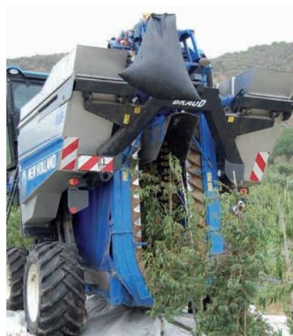
Figura 37 - 38 : Máquina New Holland Braud 9090X Olivar.
