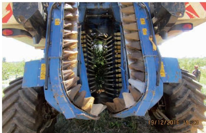
**Figura 36:** Ballestas vibradoras de la máquina en toda la altura del recolector.
