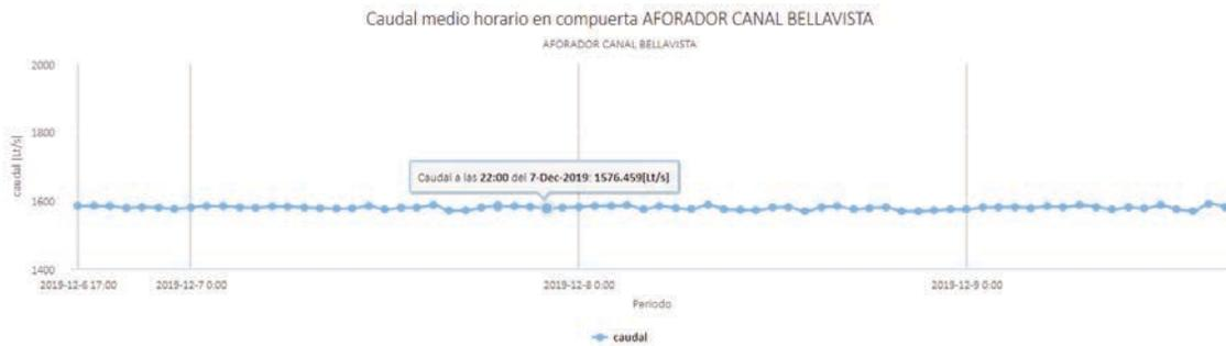
**Figura 29.** Visualizador de datos históricos de las compuertas telemétricas.
