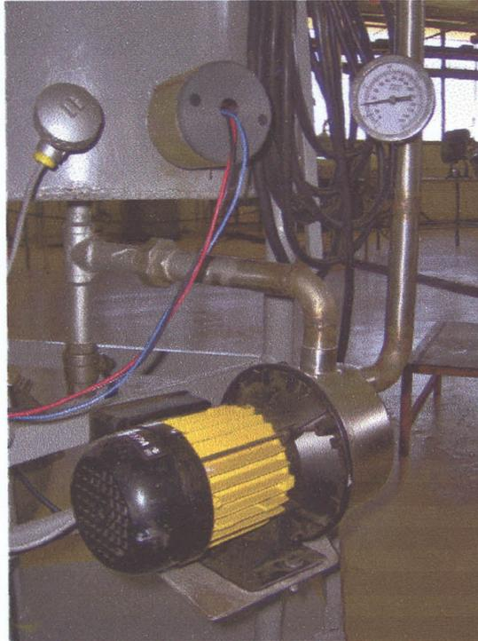
Figura 3. Detalle de la recirculación de extracto fluido y del sistema de descarga.
