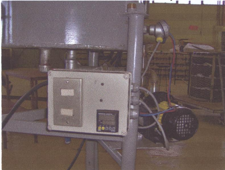
Figura 4. Detalle del sistema de control de temperatura del fluido calefactor.
