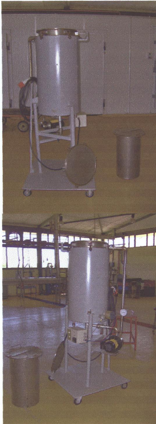
**Figuras 1 y 2. Vistas generales del equipo extractor en donde se aprecian el canastillo, la tapa, el sistema de recirculación y el controlador de temperatura.**
