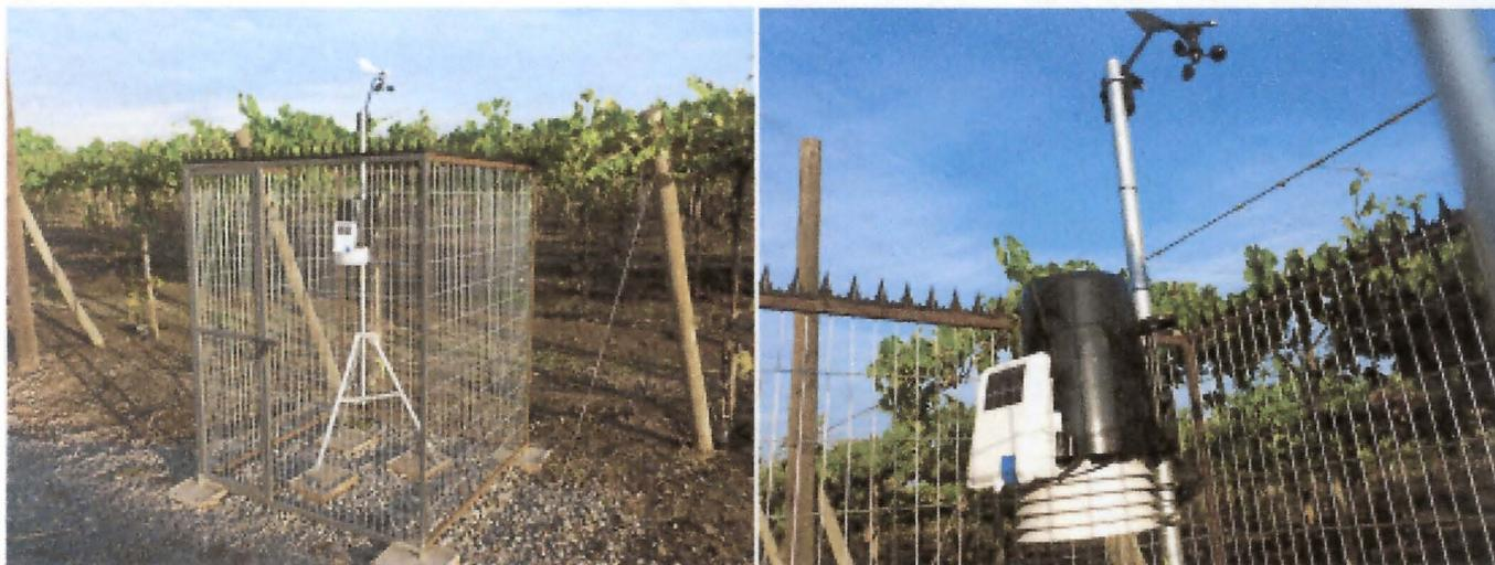
Figura 1. Estación Meteorológica marca Davis, modelo Vantage Pro 2, instalada en Talagante.
