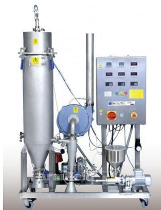
**Figura 2.2:** Secador spray modelo FT80
