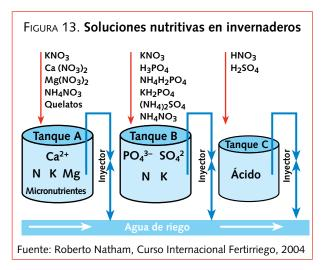
**Solución de Inyección**: Es la solución que se inyecta y circula en la red de riego y está formada por la solución madre más agua .
