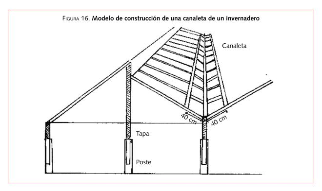
Canaleta: El ancho de la canaleta varía entre 80 a 100 cm y sirve para recoger las aguas lluvia.
