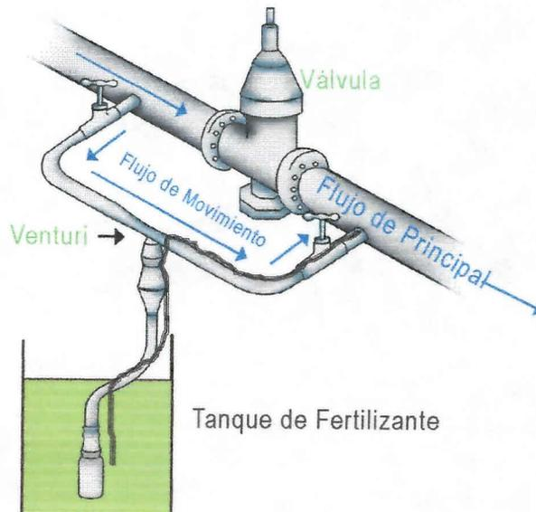
Figura 16. Funcionamiento del venturi para la inyección de fertilizante.
