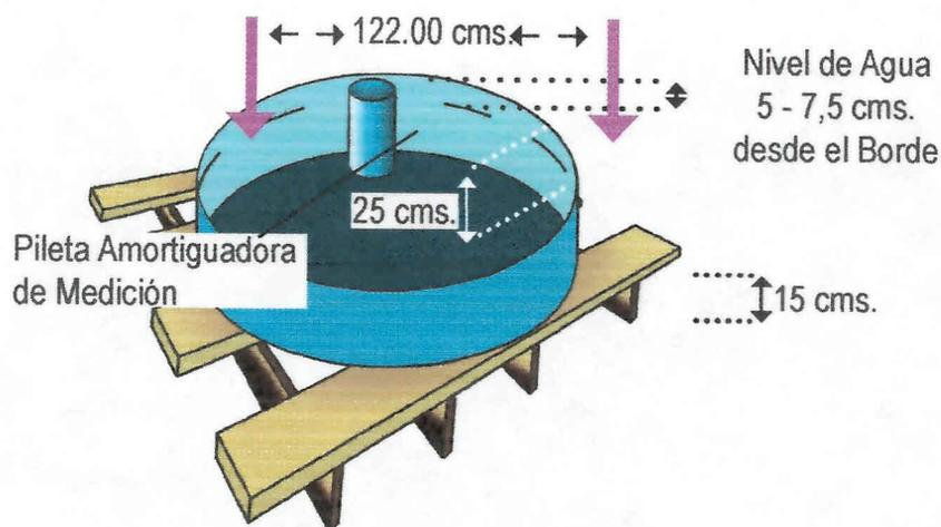
Figura 4: Bandeja de evaporación clase A
