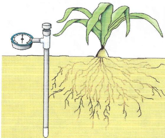
Figura 18: Tensiómetro y posición de éste.
