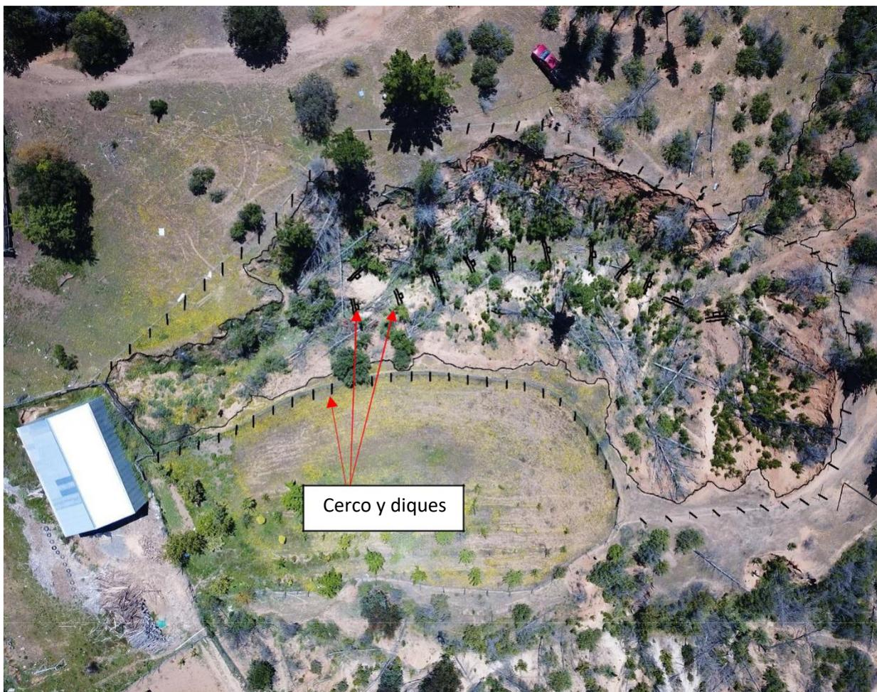
**Foto 29.** Demarcación (en color negro), de obras implementadas al interior de Cárcava. Se aprecia cercado perimetral (líneas cortas verticales) y diques de madera con disipadores (líneas negras horizontales). La ubicación es aproximada en base a datos GPS. La fotografía, es anterior al volteo, trozado y disposición de madera (troncos y ramas) de pinos muertos por incendio de 2017, los cuales se aprecian en la imagen de color gris.
