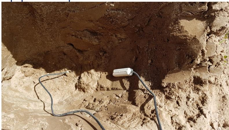
Instalación Sensores de Humedad Volumétrica
