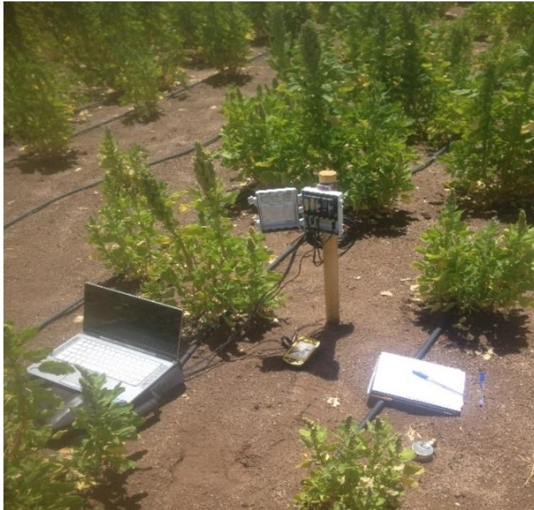
Data Logger y Sensores de Humedad del Suelo
