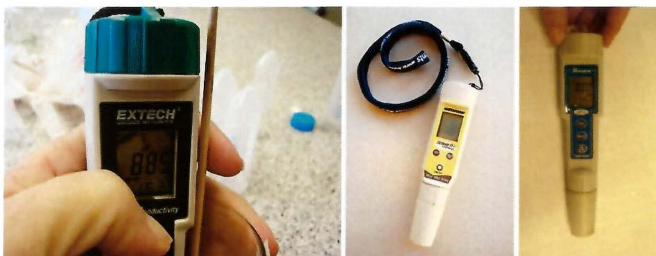
**Figura 3. Tipos de conductímetros usados en el estudio. (Obs: La mención de las marcas no indica recomendación de parte de los investigadores).**
