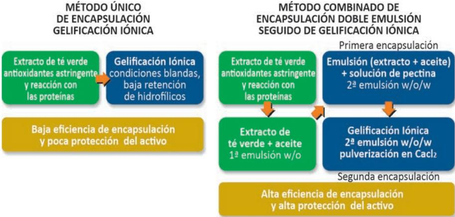
**Figura 4.13.** Comparación entre métodos único e combinado para encapsulación del extracto de té (Fuente: adaptada por I. Dutra Alvim de Cutrim *et al.*, 2019).
