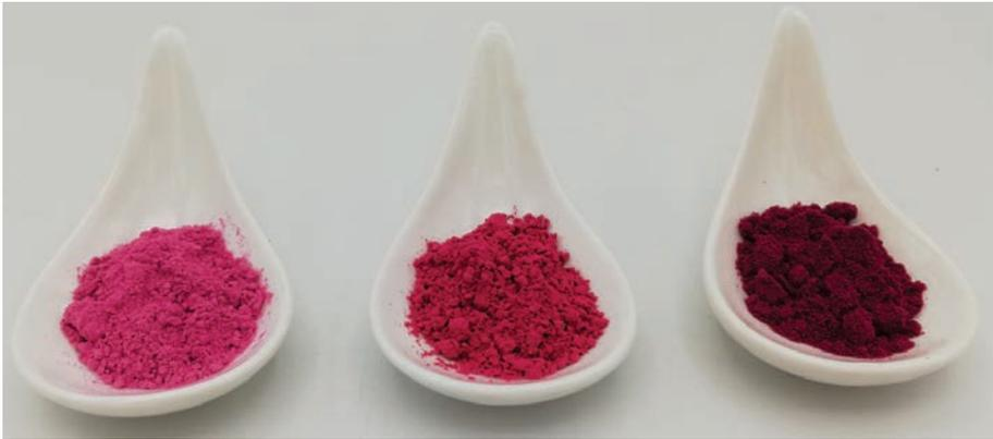
**Figura 4.6.** Micro encapsulados obtenidos en el laboratorio alimentos INIA mediante secado por atomización desde extracto líquido concentrado de zanahoria morada. La intensidad del color está dada por la concentración del extracto (Fuente: Laboratorio UMPA - INIA).
