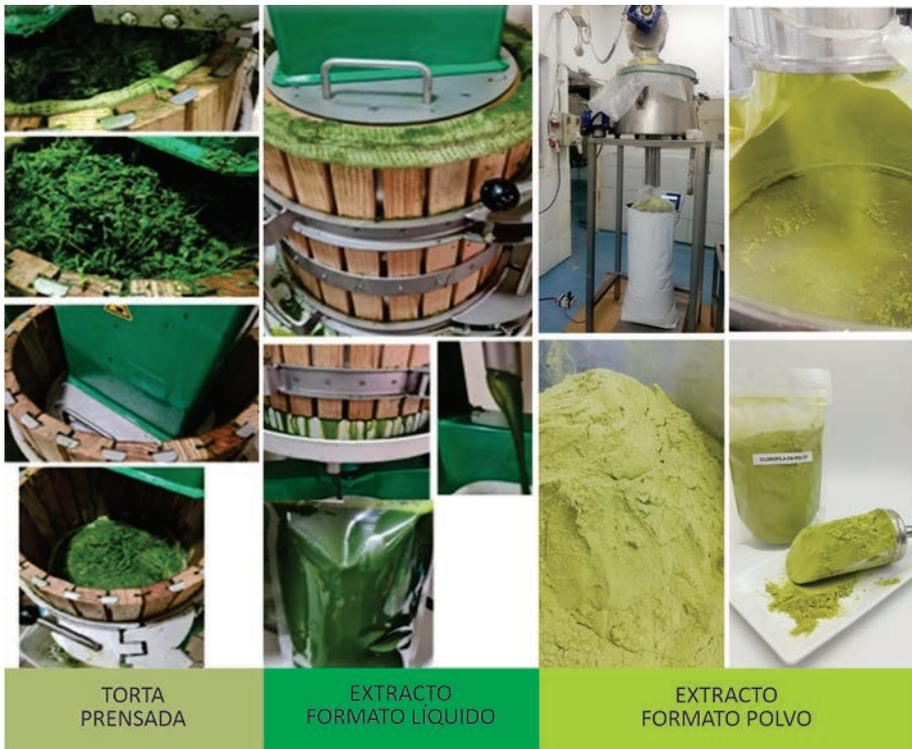
**Figura 5.23.** Procesamiento de la alfalfa para la obtención de clorofila: extracto en formato líquido (procesado en La Casona El Monte) y extracto en formato polvo obtenido a través de secado por atomización (procesado en INASEC) (Fuente: Laboratorio UMPA - INIA).
