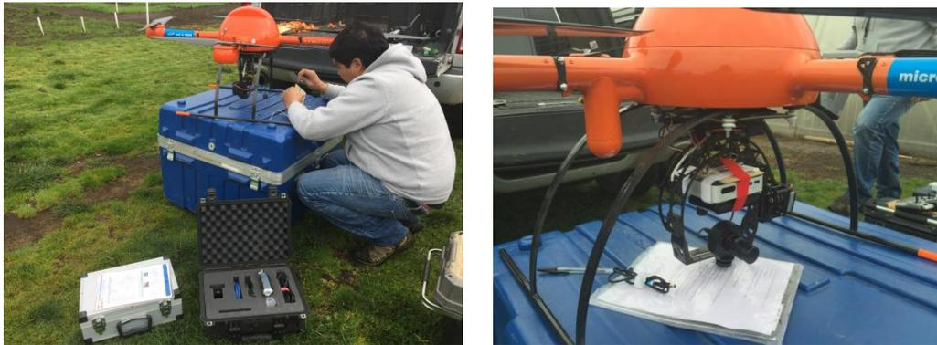
Figura 9. Preparación de sistema de captura hiperspectral en UAV Microdrone.
