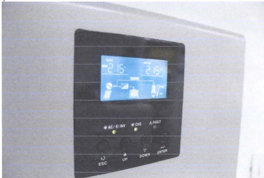
Foto 8: Inversor/cargador, permite regular la carga de los paneles solares ubicados en el techo de la unidad, nos permite autonomía eléctrica para trabajar en lugares remotos.
