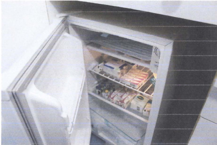
Foto 11: Unidad de Frio. Equipo diseñado para motorhome, nos permite trasladar todos los medicamentos que requieren cadena de frio (como vacunas), su consumo de 43 w/hr nos ofrece una gran autonomía.
