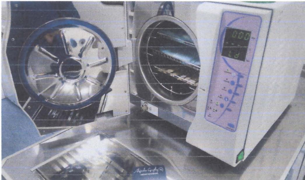
Foto 12: Autoclave, equipo usado para la esterilización de todo tipo de instrumental quirúrgico y telas (batas y paños de campo)
