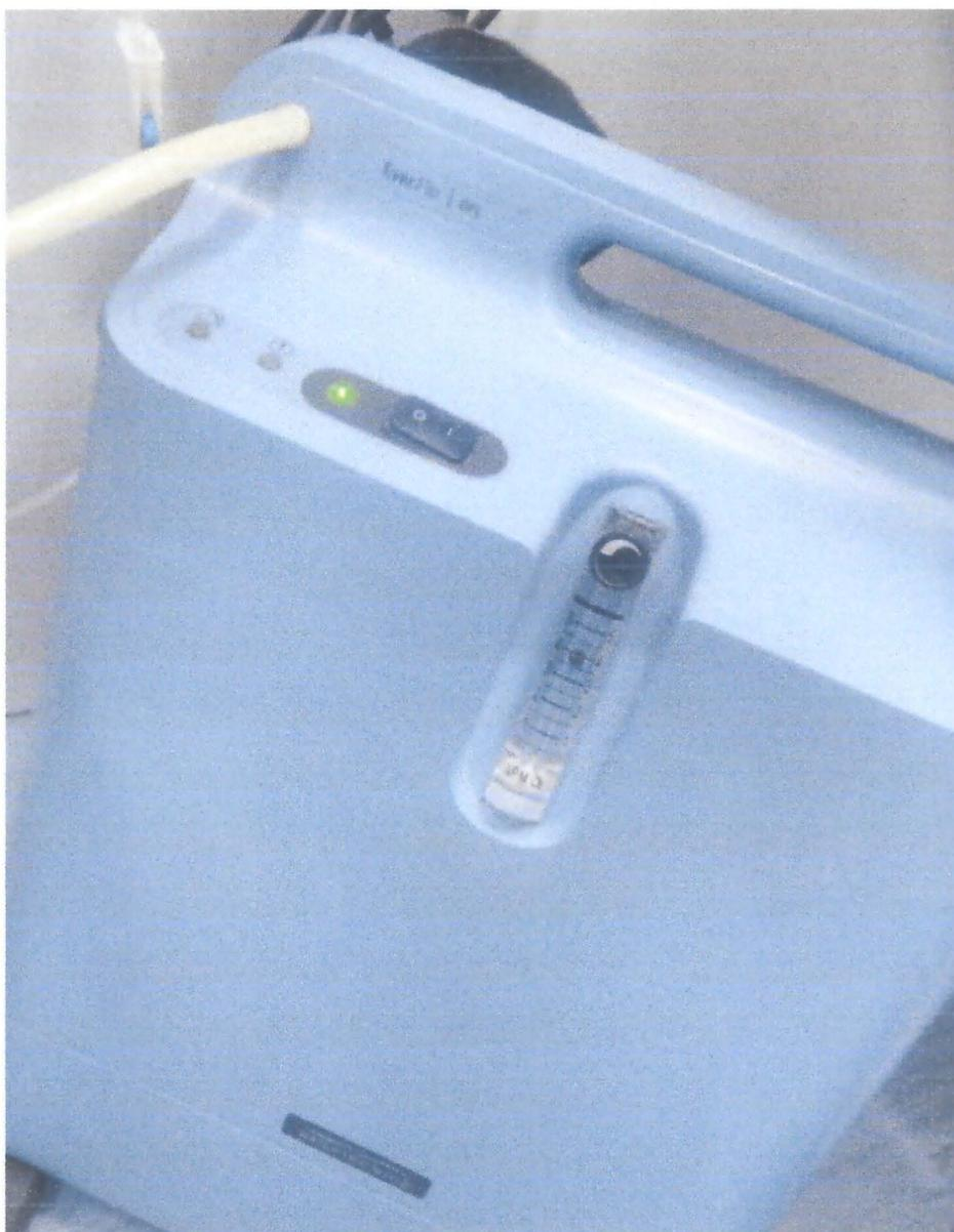
Foto 14: Concentrador de Oxígeno, este equipo toma aire ambiente y entrega un flujo constante de oxígeno al 94% de pureza, útil para oxigenoterapia y el funcionamiento de la máquina de anestesia inhalatoria.
