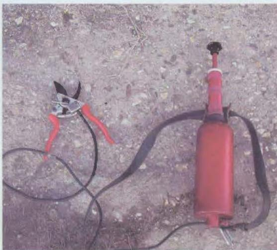
Figura 7.3. Tijera podadora provista de sistema de desinfección simultánea al corte.
