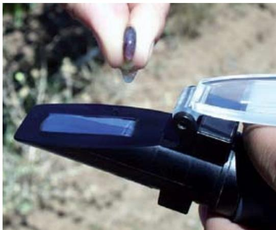
Control de madurez de uvas con refractómetro ( $^{\circ}$ Brix).
