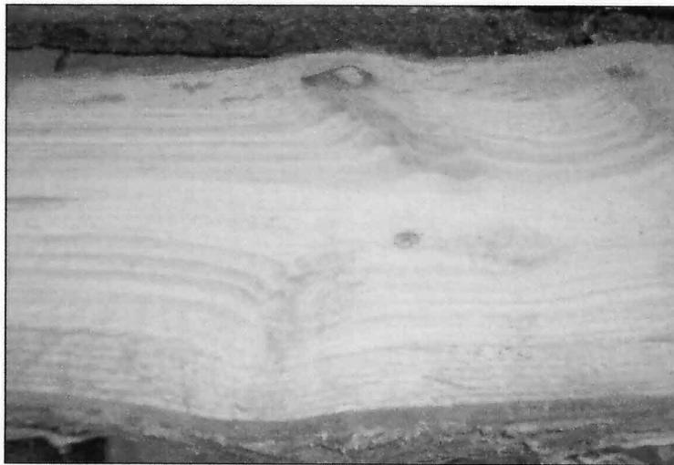
Fotografía 23: Madera aserrada de farnia procesada con el aserradero móvil instalado en Valdarno. Se observan las heridas de poda cercana a la corteza (San Giovanni Valdarno).
