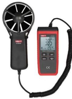
**Figura 9.** Anemómetro digital con molinete.
