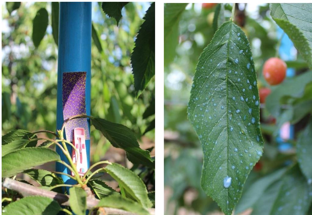
**Figura 5.** Estado de los papeles hidrosensibles (izquierda) y de las hojas a muestrear (derecha) una vez finalizada la aplicación con la mezcla agua + trazador Tinopal.
