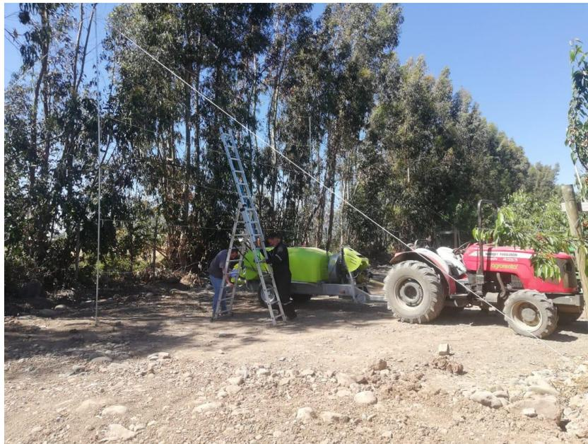
**Figura 13.** Medición de la distribución de viento de la pulverizadora no electrostática.
