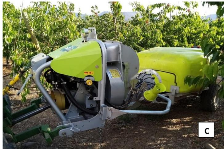
**Figura 7.** Aplicación del trazador fluorescente Tinopal® CBS-X con las diferentes pulverizadoras evaluadas. **A.** Pulverizadora hidroneumática (turbopulverizadora). **B.** Nebulizadora electrostática sin boquillas (Tendone®). **C.** Nebulizadora no electrostática sin boquillas (Optima®).
