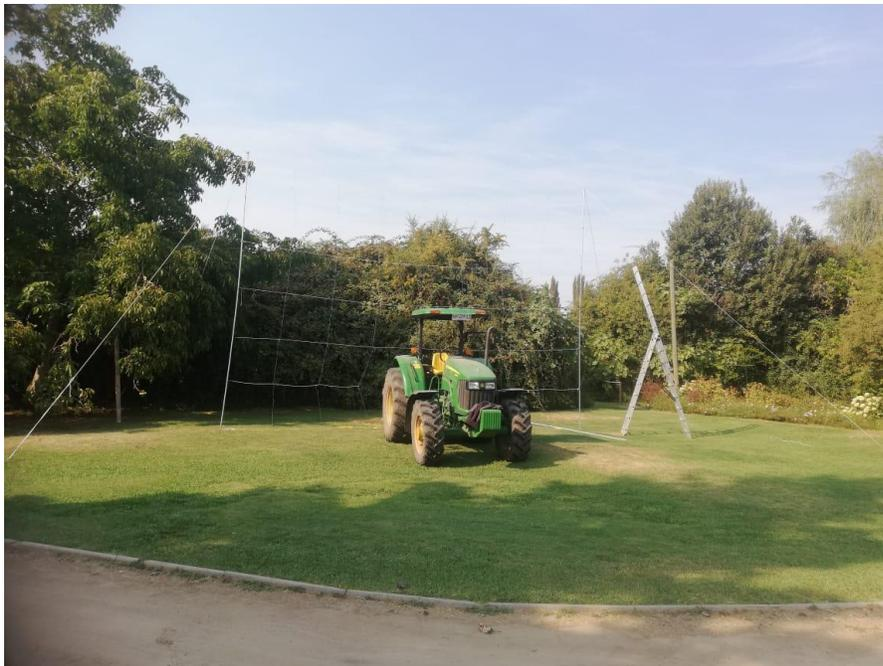
**Figura 15.** Medición de la distribución de viento de la pulverizadora electroestática.
