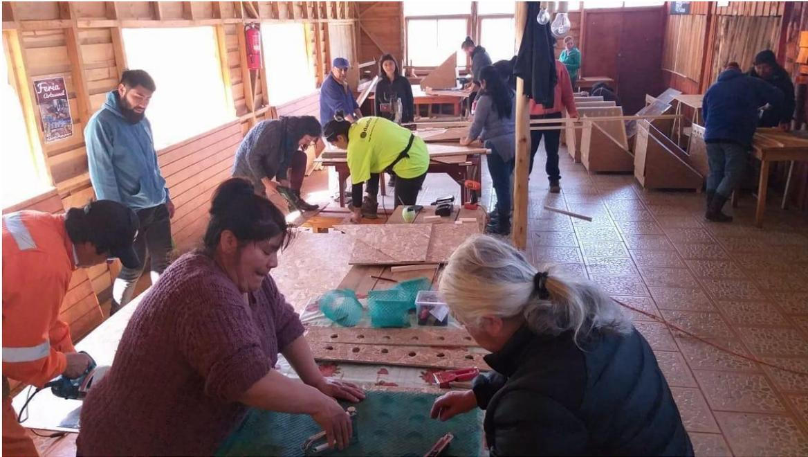
**Imagen 9.** Se observan al menos 5 cuadrillas trabajando a lo largo de la feria. De abajo hacia arriba: engrapando malla para bandeja, perforando bandejas para que tengan flujo de aire, armando las paredes (a la izquierda y a la derecha de la foto) y al fondo uniendo las piezas. Por último delante de la foto y a la izquierda maestro Jorge Llanquino cortando planchas junto a su hijo.
