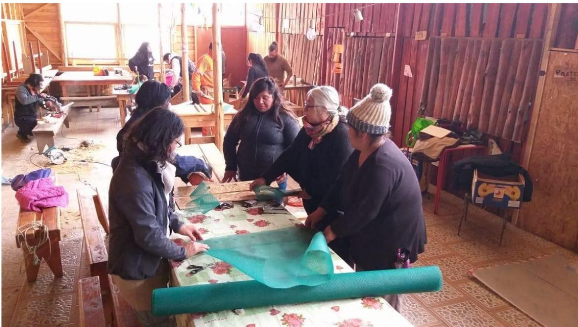
**Imagen 7.** Cuadrilla armando las bandejas. Van corcheteando con engrapadora la malla mosquitera verde.
