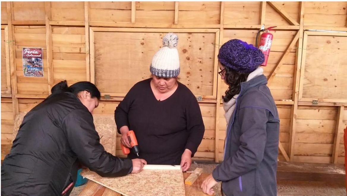
**Imagen 2.** Cuadrilla de trabajo armando con atornillador eléctrico las paredes de la deshidratadora. Se ve cómo ponen madera para sostener bandeja que va por dentro.
