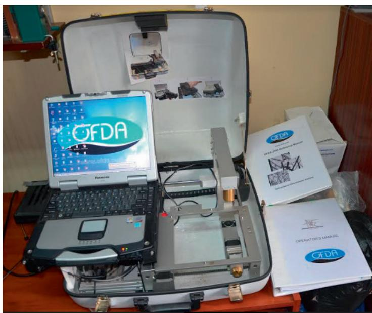
Imagen N°9: Optical Fibre Diameter Analyser (OFDA) 2000.
