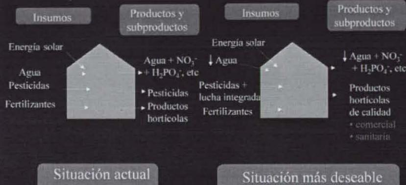
Esquema de algunas entradas y salidas en el funcionamiento de un invernadero
