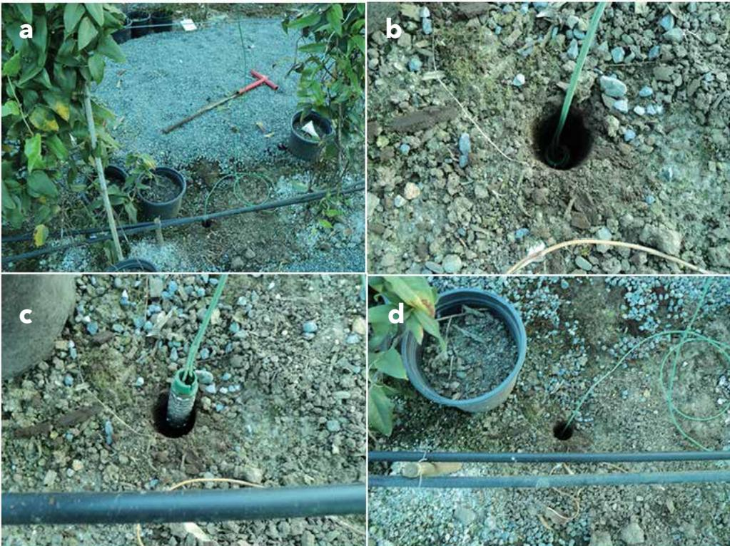
**Foto 6 a,b,c y d.** Instalación de los tensiómetros electrónicos de medición continua en el suelo en la sobre hilera de las plantas de copihues.
