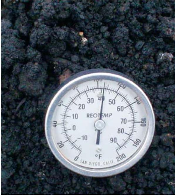
Foto 6. Termómetro para medir temperatura en pilas de compost
