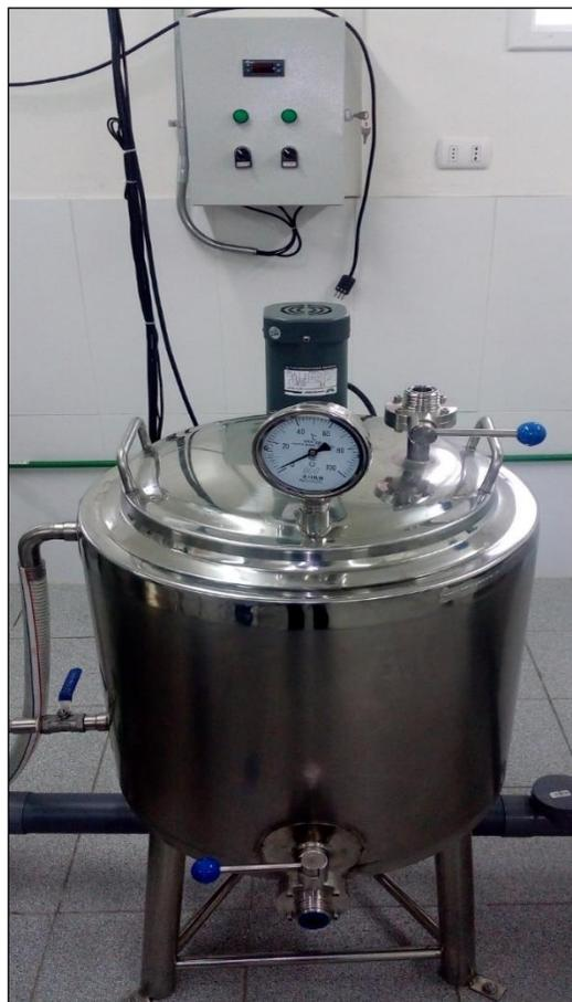
**Imagen 6.** Vista frontal del equipo pasteurizador, en la parte superior de la imagen en la pared se encuentra el panel de control de este equipo que posee un termómetro digital, encendido de la resistencia eléctrica y encendido del agitador. En la parte superior del equipo se encuentra el agitador y también un termómetro analógico, el cual ingresa su vástago al interior del equipo para llevar un control de temperatura del pasteurizado del producto.
