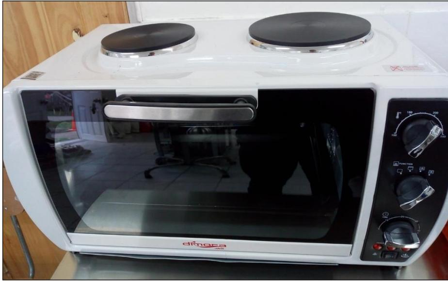
**Imagen 17.** Horno eléctrico, este equipo se encuentra conectado a la red de 220V funciona con un sistema de timer donde se programa el tiempo deseado, se puede ajustar la temperatura, pero para la finalidad deseada se trabaja a 200°C.
