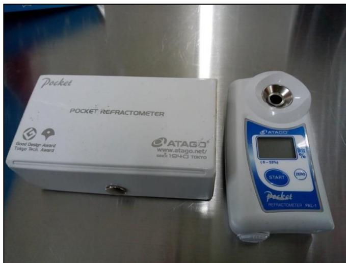
Imagen 21. Refractómetro manual
