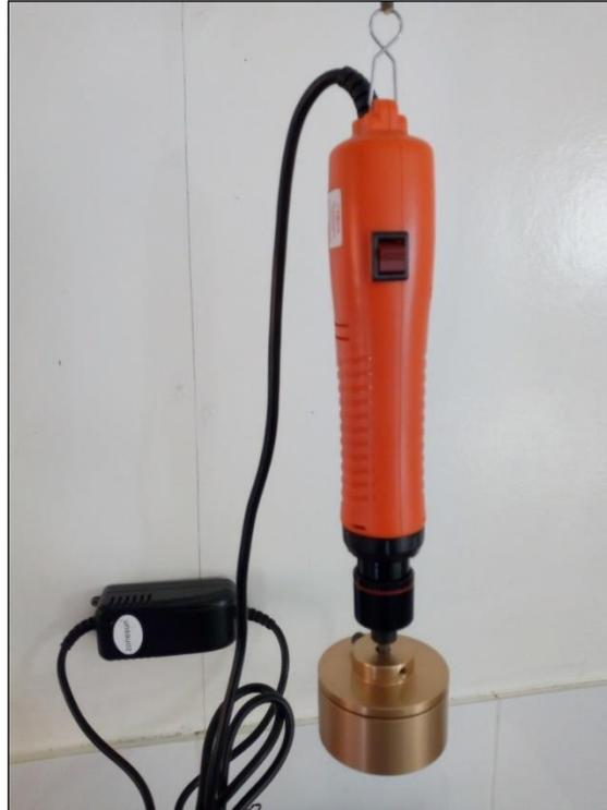
**Imagen 13.** La tapadora de botellas es de fácil uso, se encuentra colgada con un sistema de gancho y resorte, lo que facilita su manipulación, permite regular el nivel de giro de las tapas.
