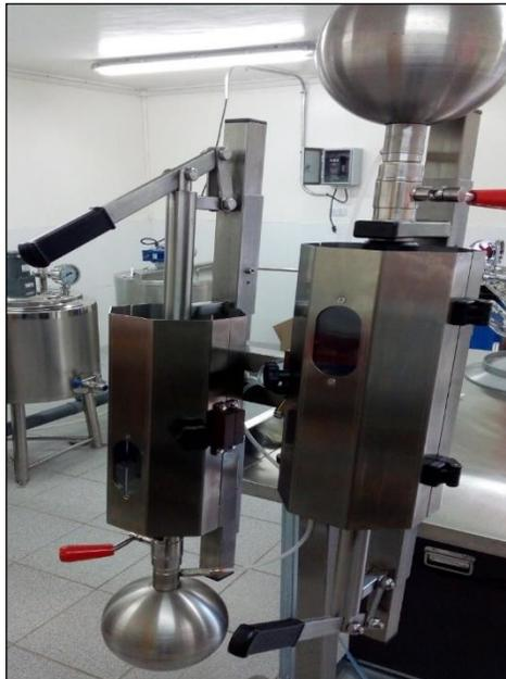
**Imagen 9.** Vista frontal del equipo saturador de CO<sub>2</sub>, posee una compuerta de seguridad por columna, donde en su interior se inserta 1 botella de producto llena, la cual se mezcla por presión con el Co<sup>2</sup> en estado gaseoso.
