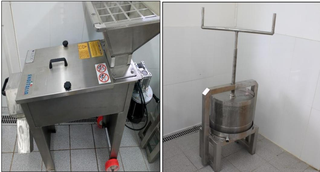
Imagen 26. Despulpadora de uso industrial discontinuo y prensa vertical dispuestas en la sala de procesos.
