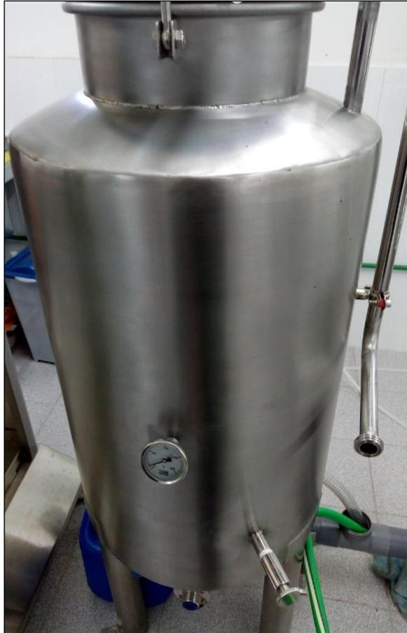
**Imagen 7.** Vista frontal del estanco de enfriamiento del producto, este estanco posee un termómetro analógico que permite el control de la temperatura interna y una llave que permite la toma de muestra del producto terminado para realizar análisis.
