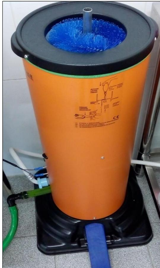
**Imagen 16.** Lavadora de botellas, funciona accionada por un pedal que impulsa agua a presión al interior y permite el lavado interno con cerdas plásticas que giran al interior de la botella, este equipo se encuentra conectado a la red de 220V y debe tener un suministro de agua y una conexión para la eliminación del agua.
