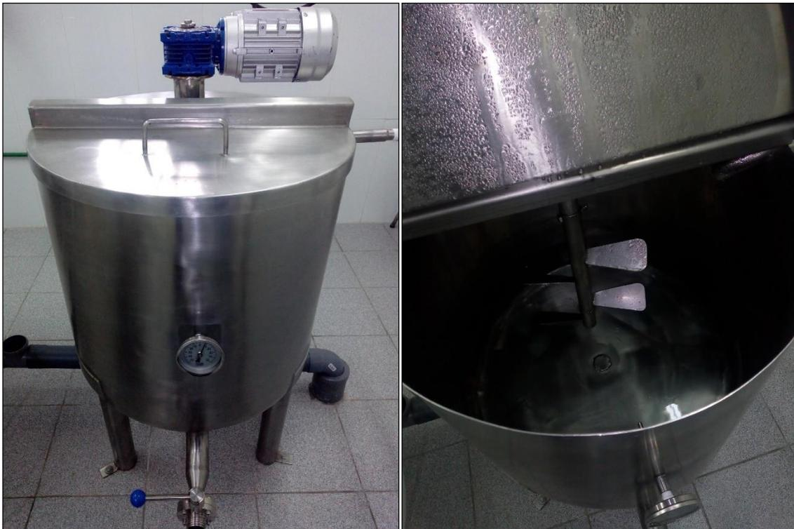
**Imagen 5.** (Izquierda) vista frontal del equipo Homogenizador, (derecha) vista interior del equipo homogenizador. El tiempo que permanecen los ingredientes en su interior variara dependiendo de la receta a elaborar, se puede ajustar la velocidad de las espas de rotación desde 20 rpm a 60 rpm, desde el tablero de control.
