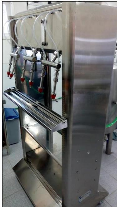
**Imagen 12.** Llenadora de botellas para línea de producto sin gasificar, este equipo permite el llenado de hasta 4 botellas de manera simultánea, ya que cada boquilla posee un sistema de corte de llenado, la cantidad se encuentra limitada por la velocidad de tapado de las botellas calientes.
