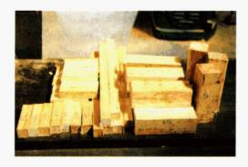
Probetas de ensayo para resistencia mecánica
