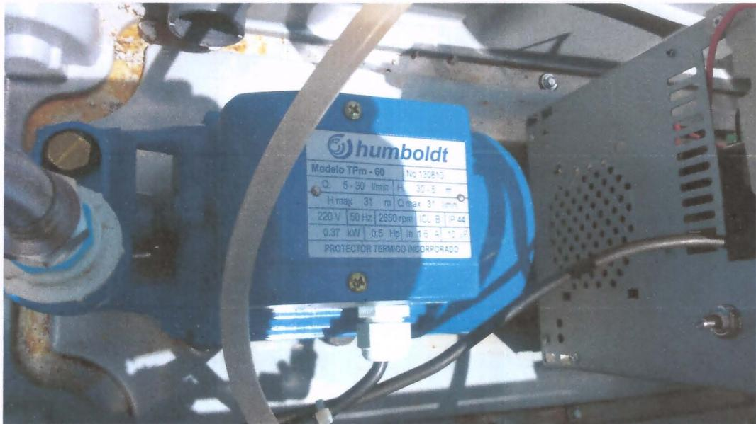
Foto 3, Bomba de recirculación de agua de enfriamiento.
