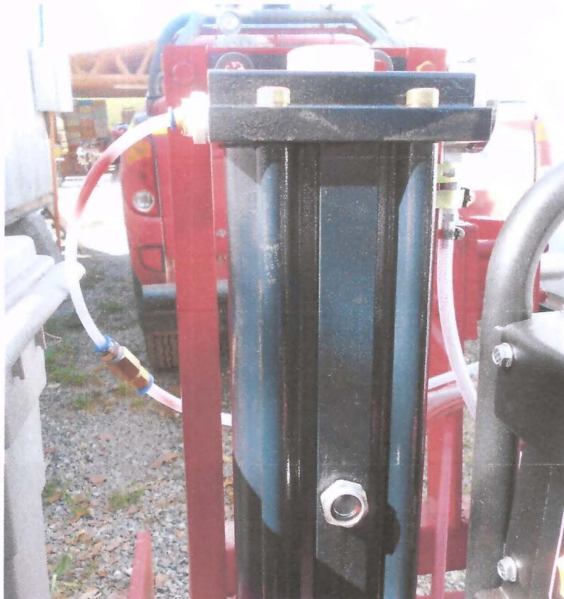
Foto 6, Filtro de aire comprimido.
