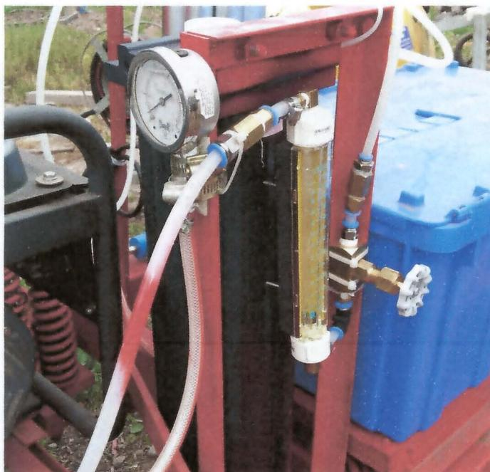
Foto 8, Flujómetro y válvula reguladora de oxígeno.
