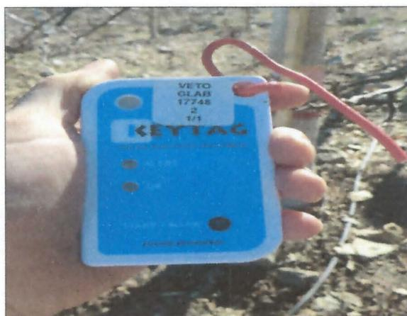
**Figura 3. Registrador de temperatura y humedad ambiental Keytag H4011206.**
