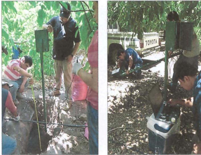
Figura 1. Instalación de sensores EC-5 Decagon en parcelas experimentales.
