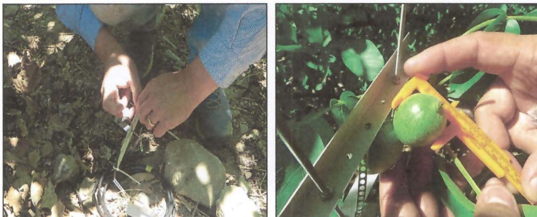
**Figura 5. Armado de dendrómetro de fruto tipo DF en terreno (izquierda). Medición con pie de metro de cada uno de los frutos a evaluar, previa instalación de dendrómetro de fruto en parcela experimental de Barraco, comuna de Salamanca (derecha).**
