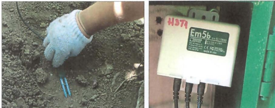
Figura 2. Sensor de humedad continúa EC-5 Decagon (izquierda) y registrador de datos EM-5b (derecha).
