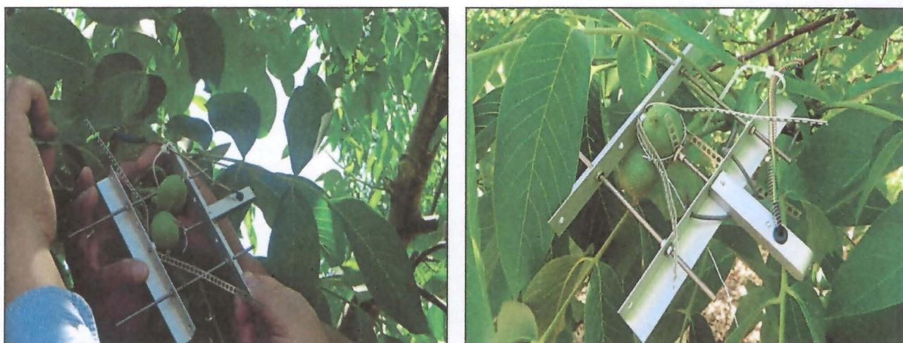
**Figura 6. Instalación de dendrómetro de fruto en nogal (izquierda). Vista general de dendrómetro de fruto ya instalado (derecha).**
