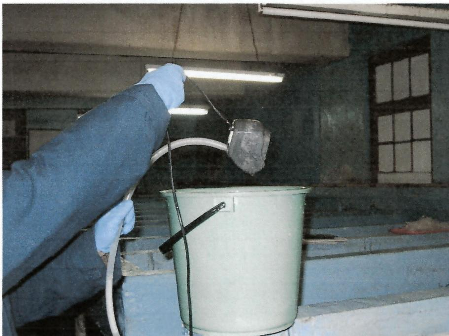
**Figura 11. Bomba utilizada para la distribución de la solución de Bronopol en la batea.**
