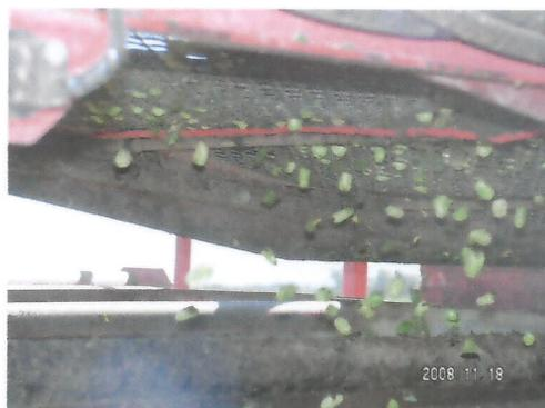
Figura 32. Mallas del sistema de limpieza
