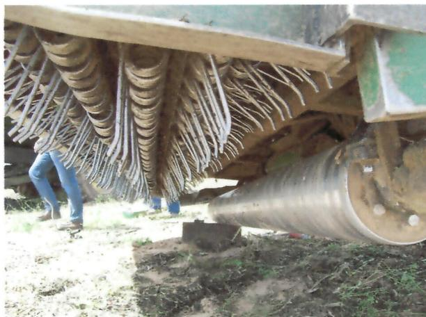
**Figura 3.** Cabezal tipo stripper, máquina cosechadora Ploeger
