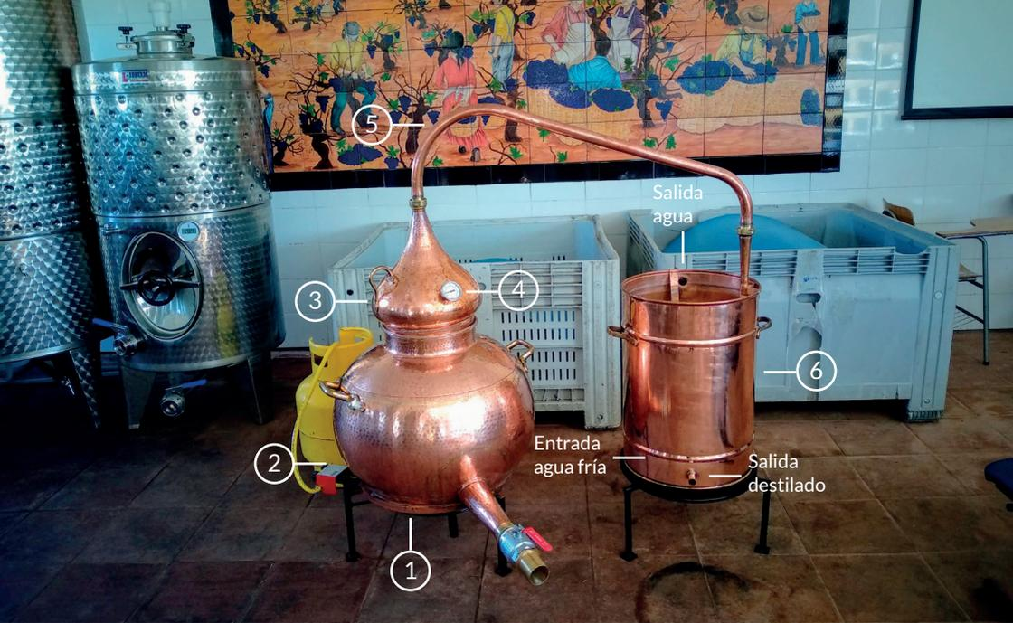
Figura 4.1 Alambique hidráulico de cobre, de 50 litros de capacidad marca Maritas, con sus partes principales.
