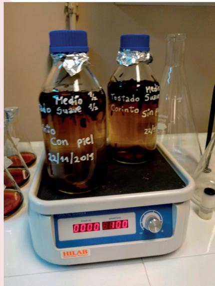
Foto 25. Ejemplo de envejecimiento mediante vibración mecánica de chips de roble francés con holandas, en condiciones de laboratorio con agitador programable, para acelerar reacción de extracción.
