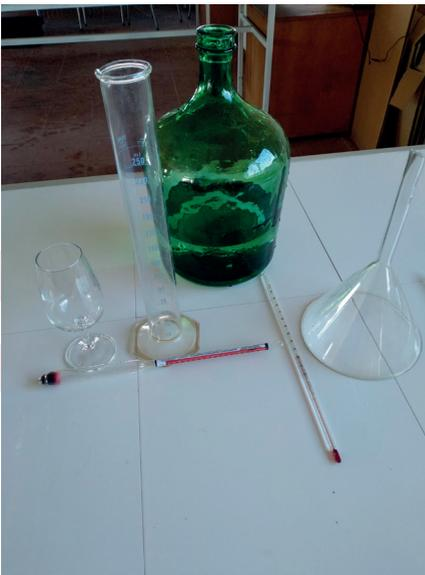
Foto 34. Registro y medición del producto destilado, con densímetro, termómetro y probeta.
