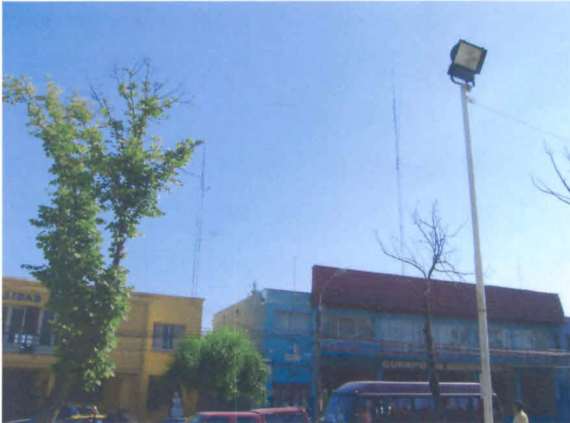
Ambos edificios tienen torres ventadas con antenas instaladas. La de la Municipalidad tiene 18 mts de altura y los bomberos 24 mts de altura.
