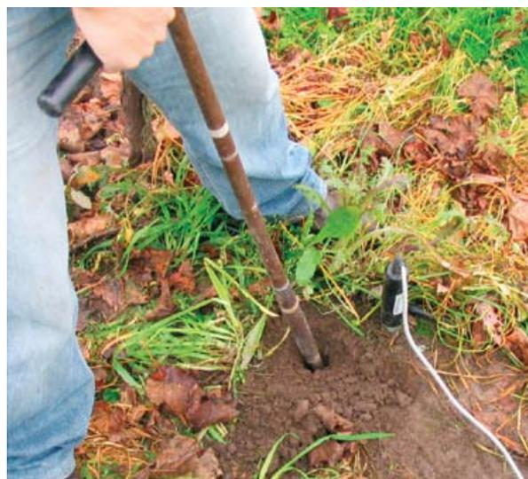
Foto 2. Muestra de suelo a través de un barreno
