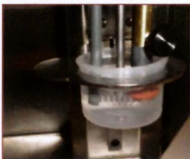
Es en la celda de medida donde tras añadir el sustrato con un contenido de ácido glucónico por determinar se da esta reacción de oxidación, en unas condiciones de corriente y pH óptimas, entre los electrodos de referencia, contra electrodo y Biotest con la ayuda de un agitador.
