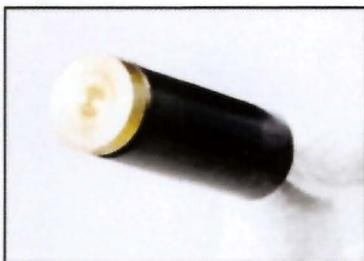
La tecnología BIOLAN se basa en su electrodo de trabajo o Biotest, donde va depositada la enzima capaz de oxidar el ácido glucónico de forma selectiva
