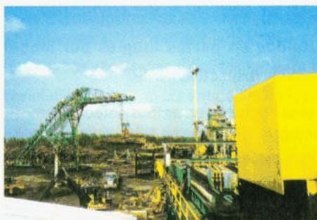
**Sistema de carguío de trozas a la línea de descortezado para posterior ingreso a aserrío**
