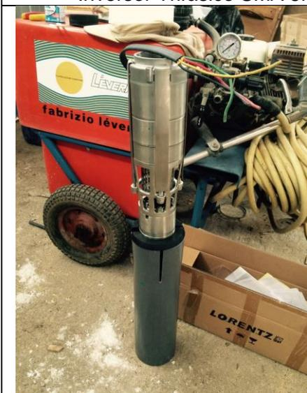
Bomba Sumergible con camisa refrigeración instalada
