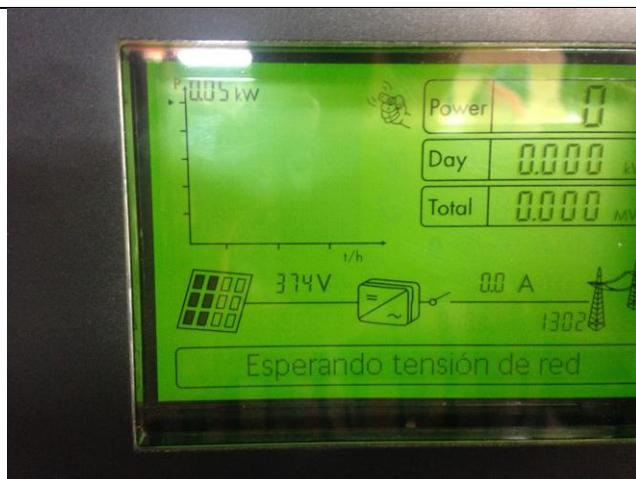
374V de tensión fotovoltaica en inversor.
