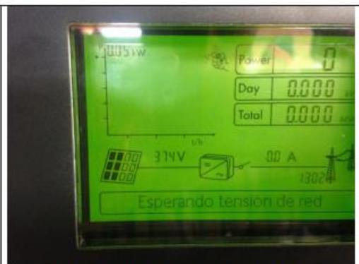
374V de tensión fotovoltaica en inversor.
